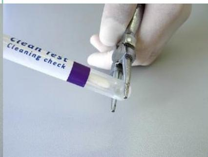
Раздавите пинцетом стеклянный флакон внутри пробирки
