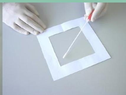
Взять смыв на поверхности размером 10 x 10 см.
