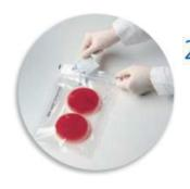
Извлечь газогенерирующее саше GasPak EZ и поместить его в пакет. При использовании анаэробной системы GasPak EZ добавить саше с индикатором.
