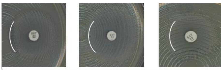
Рис. 18. Учет проводится по любой различимой границе зоны подавления роста. Тонкий рост внутри зоны не учитывается. Изолят чувствительный (если d \geq 16 мм)
